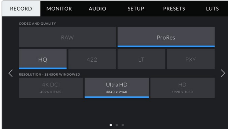
RECORD, MONITOR, AUDIO, SETUP, PRESETS, LUTS를 탭하면 Pocket Cinema Camera 4K의 대시보드 탭으로 이동합니다.
