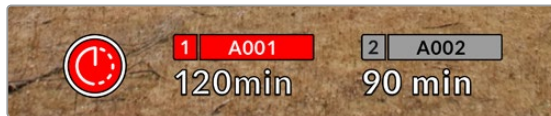
Blackmagic Pocket Cinema Camera 4K会在记录按钮上方叠加显示一个图标，以提示摄影机处于间隔拍摄模式。
