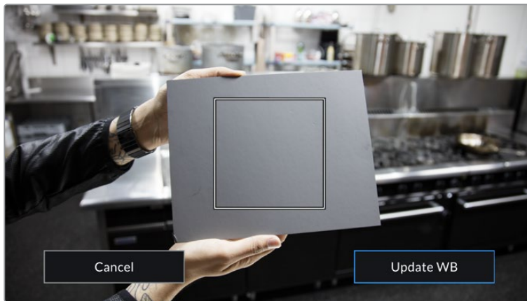
화이트 밸런스 메뉴에 있는 AWB 아이콘을 누르면 자동 화이트 밸런스 화면이 나타납니다. 흰색 또는 중립적인 회색면을 함께 사용해 자동으로 중립적인 화이트 밸런스를 설정하세요.
