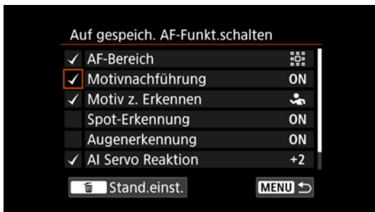
Abb. 3.20 Sie müssen vor jeder der Optionen einen Haken setzen, damit diese auch aktiviert werden.
