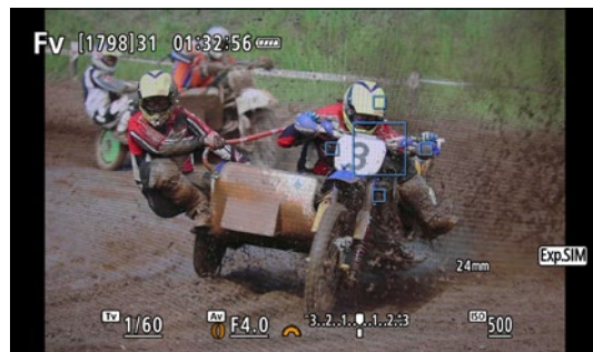
Abb. 3.8 Wenn das Ziel immer aus einer Richtung kommt, dann reicht es, den Autofokus-Bereich mit vier Feldern zu wählen, da die Bewegungen vorhersehbar sind.
