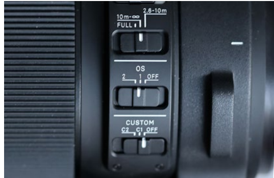
Abb. 3.40 Sie können den Autofokus in so einem Fall unterstützen, indem Sie (sofern an Ihrem Objektiv vorhanden) über den Fokus-Limiter den scharfzustellenden Bereich eingrenzen.
