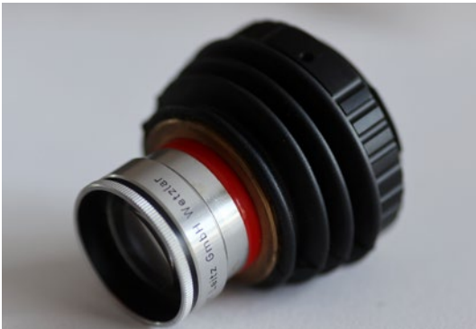
Abb. 3.26 Diese Squeezerlens besteht aus einem alten Projektorobjektiv, und die Fokussierung erfolgt mittels Balgen und Fingern rein manuell.
