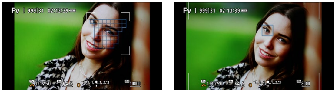
Abb. 3.11 In der kleinen Zone funktioniert die Augenerkennung ebenso präzise wie in dem Modus »Gesamtbereich«. Bei geschickter Wahl der Lage der Zone entfällt die ständige Nachjustierung des Einzelfeldes, wenn das Modell sich bewegt. Die Zone am Anfang erkennt das Gesicht, schaltet dann auf das erkannte Auge und bleibt »dran«.
