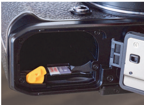
Abbildung 1.4 Um die microSD-Karte leichter einsetzen zu können, sollten Sie den Akku entnehmen.
