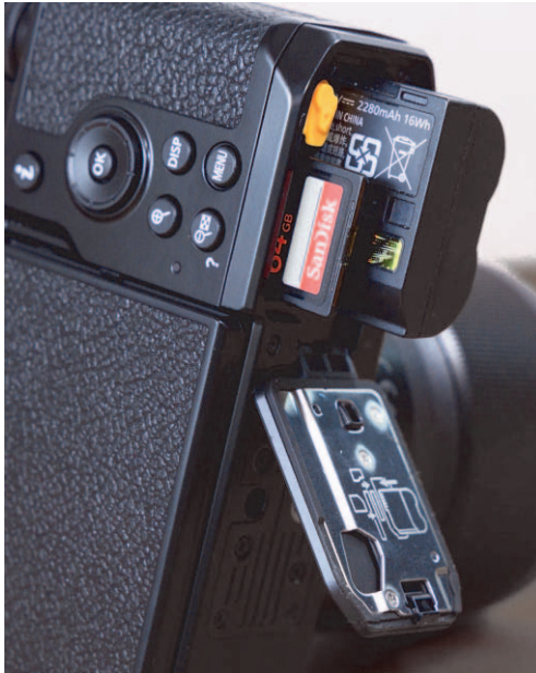
Abbildung 1.3 Auf der Unterseite befindet sich das Fach für den Akku und die Speicherkarten.
