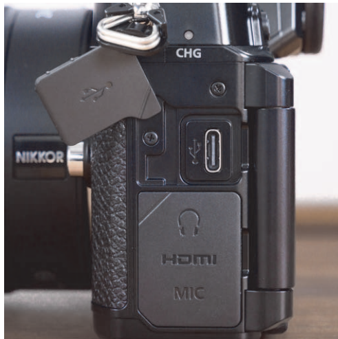
Abbildung 1.5 Über den USB-C-Anschluss kann die Kamera mit Strom versorgt und der Akku geladen werden. Etwas darüber sehen Sie die mit CHG markierte LED.
