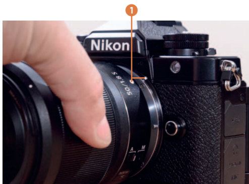
Abbildung 1.12 Richten Sie das Objektiv beim Ansetzen an den weißen Markierungen 1 am Objektiv und an der Kamera aus.
