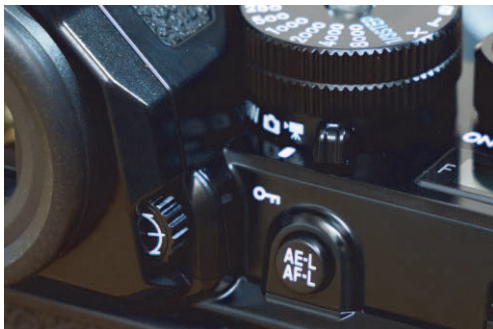
Abbildung 6.2 Für die Videoaufnahme müssen Sie den Wahlschalter auf das Filmkammersymbol stellen.
