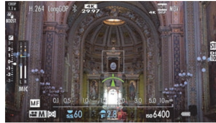
Abbildung 9.6 Das Focus Meter ist ebenfalls eine tolle Hilfe beim Fokussieren im manuellen Modus. Ist die Anzeige grün, dann ist der Bereich im weißen Rahmen scharfgestellt.
