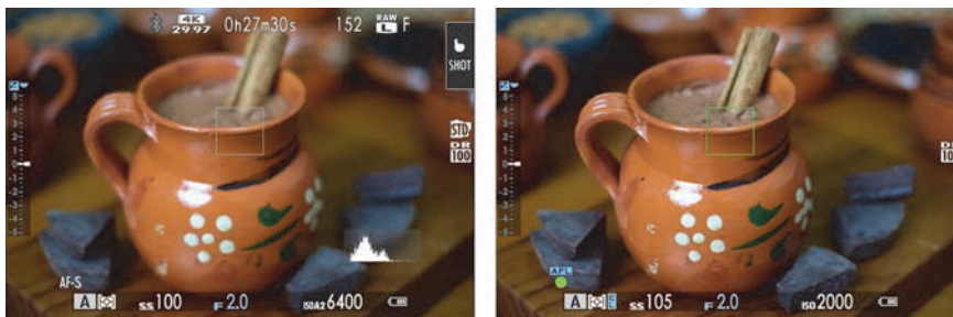
Abbildung 2.20 Links: Blende einstellen (hier: F2 ). Rechts: Wenn Sie den Auslöser halb herunterdrücken, sollten Sie die Belichtungszeit (und eventuell auch den ISO-Wert bei Auto-ISO) überprüfen, weil Sie dann die tatsächlich verwendeten Werte sehen.
