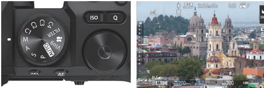
Abbildung 2.22 Links: Wenn Sie den Programmmodus M aktiviert haben, liegt es an Ihnen, die Belichtung einzustellen. Rechts: Den manuellen Programmmodus der Kamera erkennen Sie am M links unten und an der Blaufärbung von Belichtungszeit- und Blendenangabe. Zur Kontrolle der Belichtung dient die Belichtungsskala auf der linken Seite.
