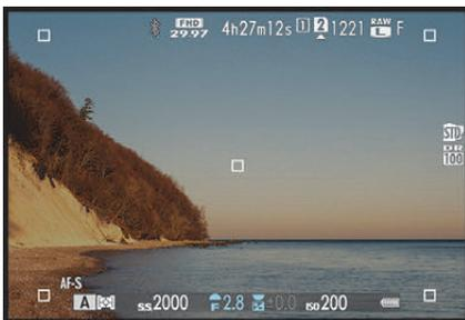
**Abbildung 3.3** Die vier Eckpunkte und die Mittelposition der fokussierbaren Bildfläche der X-H2(S) – simuliert dargestellt mit dem **EINZELPUNKT** geringster Größe
