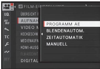
Abbildung 5.1 Im Modus **MOVIE** wird der **AUFNAHME-MODUS** im Menü oder Schnellmenü eingestellt.
