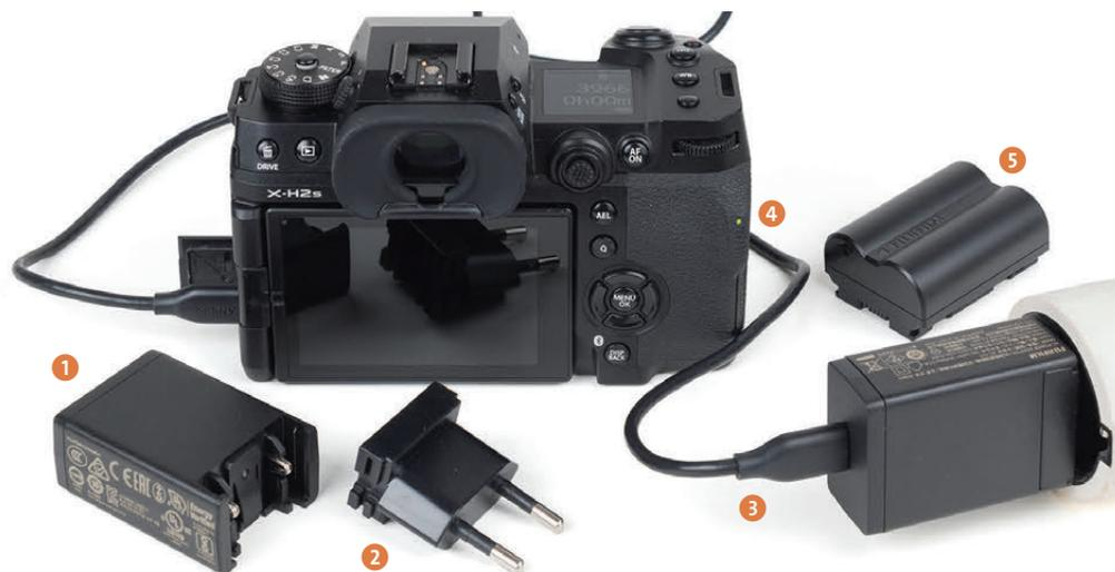
**Abbildung 1.11** Setzen Sie Netzadapter und Steckeradapter zusammen und laden Sie den Akku anschließend in der ausgeschalteten Kamera auf.
