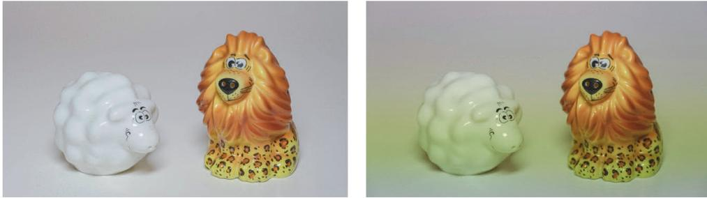
**Abbildung 2.50** Kein Banding bei manuell passend eingestellter Belichtungszeit (links); Banding bei zu kurzer Belichtungszeit (rechts)
