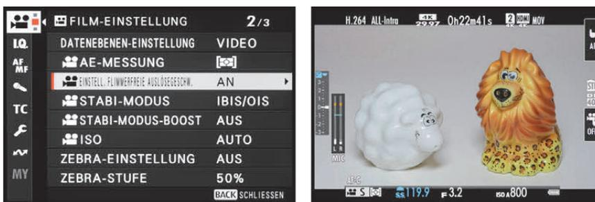
**Abbildung 2.51** Flimmerfreie Auslösegeschwindigkeit einschalten (links); Belichtungszeit anpassen (rechts)
