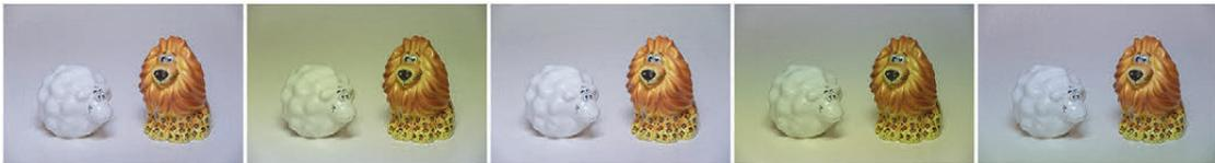
**Abbildung 2.48** Ungleichmäßige Belichtung bei 1/500 s ohne Flimmerreduzierung
