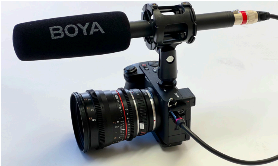
Das Boya XLR BY-BM 6060 Kondensator-Richtmikrofon (Keule) mit optionalen Adapterkabel von XLR - Stecker auf 3,5mm Klinkenstecker.
