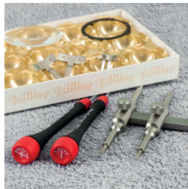
Handtuch, Schraubendreher, Spann- schlüssel und eine Pralinschachtel als Grundausrüstung für Reparaturen.
