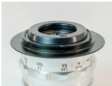
M42-Adapter für Nikon ohne Kragen passen auch auf das alte Tessar.
