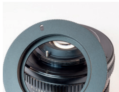
Der Kragen des Adapters drückt einen vorhandenen Blendenstift ein.
