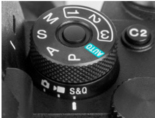
▲ Aufnahmebereich S & Q und Programm einstellen, hier die Zeitpriorität (S).
