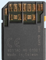
▲ Rückseite einer SD-Karte vom Typ UHS-II.
