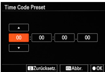
▲ Time Code Preset für neue Projekte auf null zurückstellen.
