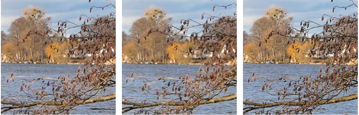
▲ Links: 4K | 60p, Mitte: 4K | 30p Vollformat, rechts: 4K | 30p APS-C S35 mm An den Bildausschnitten ist zu erkennen, dass die Oversampling-Methode (Ausschnitt rechts) ein detailreicheres, schärferes Bild liefert.
