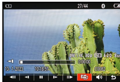
▲ Wiedergabeoptionen, hier die Schaltfläche für das Extrahieren eines Einzelbilds.
