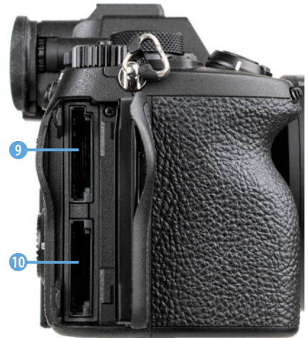
▲ Speicherkartensteckplätze, Steckplatz 1 oben und Steckplatz 2 unten.
