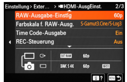
▲ Bildrate und Farbskala (Gamma, Farbmodus) einstellen.
