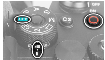
▲ Filmen aus dem Foto- oder Filmmodus heraus. Zum Starten und Stoppen dient die große, rot markierte MOVIE -Taste.
