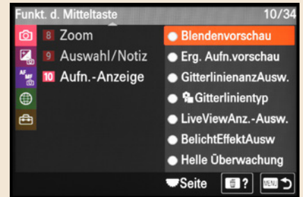
▲ Zuweisen der Blendenvorschau, hier durch Programmieren der Mitteltaste.
