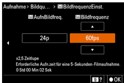
▲ Maximal ×2,5 Zeitlupe in 4K oder maximal ×5 Zeitlupe in FHD möglich.
