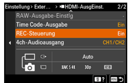
▲ Die ferngesteuerte Aufzeichnung ist nur möglich, wenn der Time Code mit ausgegeben wird.
