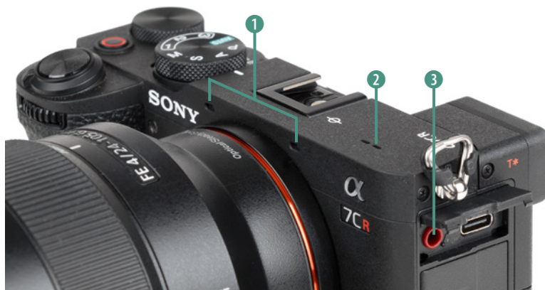
► Mikrofon, Lautsprecher und Anschluss für externe Mikrofone.
