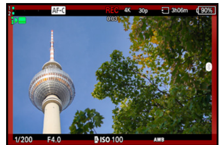
▲ Laufende Aufnahme mit Anzeige des roten REC-Rahmens als optische Unterstützung.
