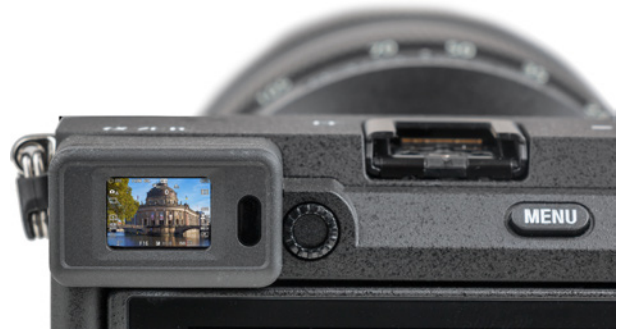
▲ Der elektronische Sucher der \alpha 7CR : Durchmesser ca. 1,0 cm (0,39 Zoll), Bildfeldabdeckung 100 %, -4 bis +3 Dioptrien.
