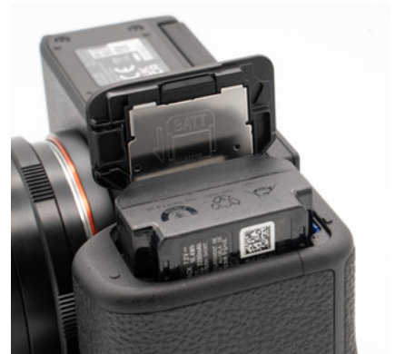
▲ Der Energiespeicher muss mit den Kontakten voran und der bedruckten Seite vom Objektiv weg eingeschoben werden.
