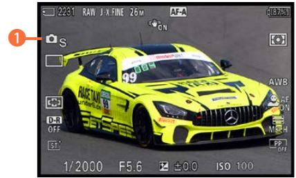
▲ Die Blendenautomatik wird mit einem **S** gekennzeichnet.
