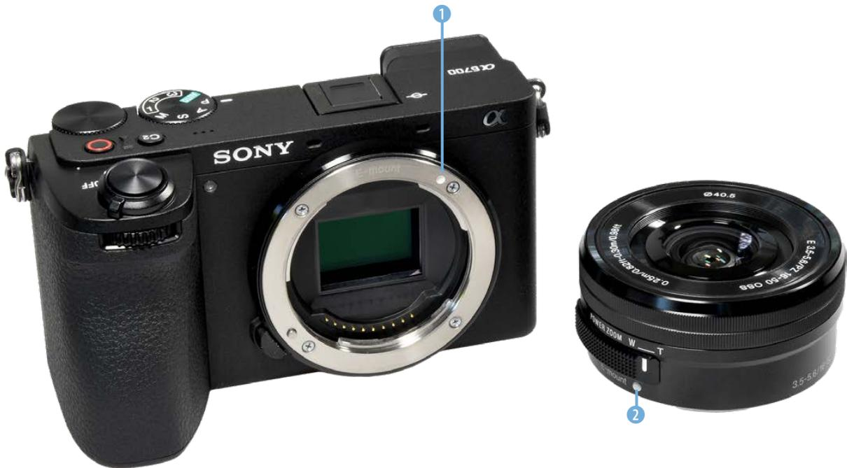
▲ Markierungspunkte zeigen an, wie das Objektiv angesetzt werden muss.
