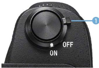
▲ Schalten Sie die Kamera mit diesem Schalter ein oder aus.
