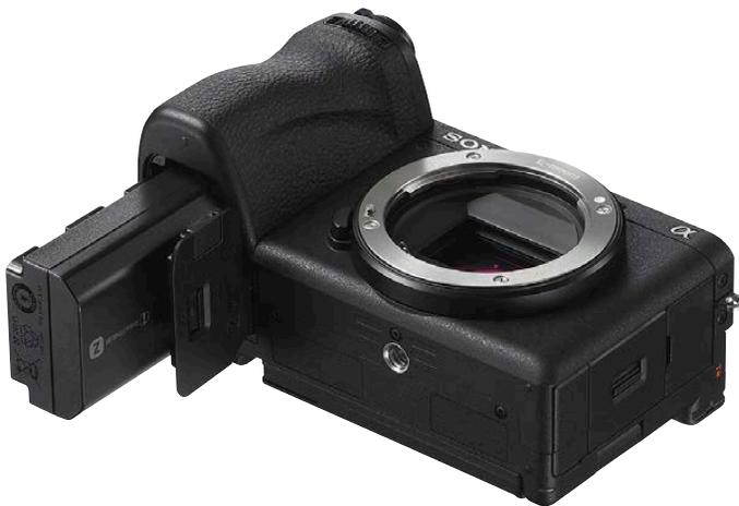
◀ Schieben Sie den Akku mit dem Pfeil in Richtung Objektiv in das Akkufach.
