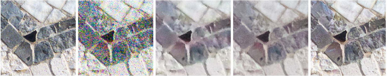
▲ Linker Ausschnitt: ISO 100, anschließend ISO 25.600 in der Reihenfolge: RAW ohne Rauschunterdrückung, JPEG aus der G9II, RAW-Entwicklung mit SILKYPIX Developer Studio und RAW-Entwicklung mit Adobe Lightroom Classic (Funktion Entrauschen ).
