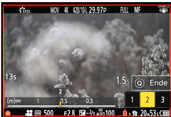
▲ Hier ist die G9II bei laufender Videoaufnahme gerade dabei, die Schärfe vom Vordergrund ( POS 1 ) auf einen Zweig weiter hinten ( POS 2 ) zu verlagern.
