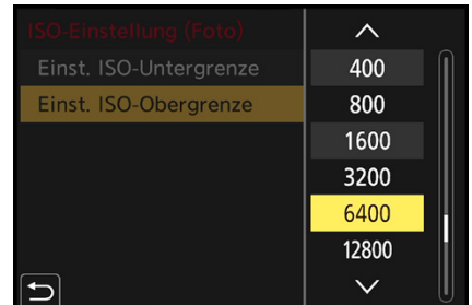
▲ Die Obergrenze der ISO-Automatik selbst wählen, hier um eine Stufe höher als der Standard für Fotoaufnahmen.
