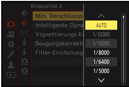
▲ Mit der automatischen Min. Verschlusszeit orientiert sich die Belichtungszeit im Modus P und A an der Objektivbrennweite.
