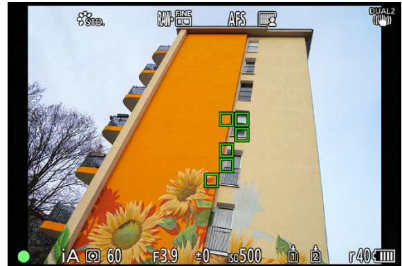
▲ Fokussieren im Modus intelligente Automatik, hier mit sechs aktiven AF-Feldern auf dem Gebäude.
