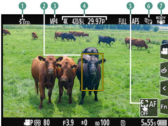
▲ Programmautomatik für Movies. Die Motiverkennung ANIMAL+HUMAN hat die Kühe erkannt und einen Fokusrahmen darumgelegt ②. Um den AF-Verfolgungsmodus abzubrechen, berühren Sie AF OFF ⑤.
