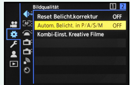
▲ Mit dieser Einstellung werden die Belichtungswerte der Modi P, A, S oder M auf daraus gestartete Videofilme übernommen.
