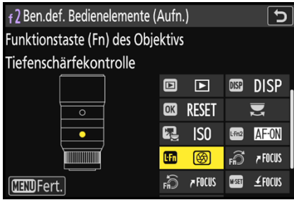
▲ Die L-Fn-Taste soll im Fotomodus der Kontrolle der Schärfentiefe dienen.
