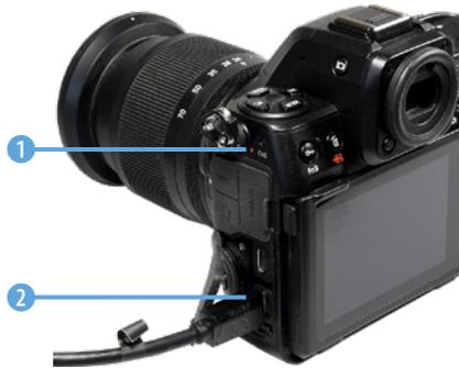
▲ Über den Anschluss **USB-PD** kann der Akku **EN-EL15c** geladen werden.
