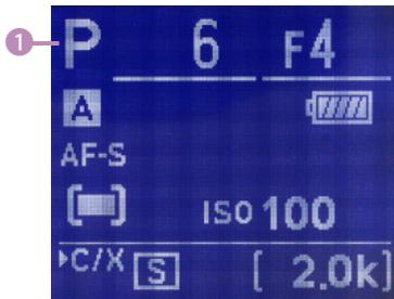
▲ Die eingestellte Belichtungsmessart wird auch im OLED-Display angezeigt.
