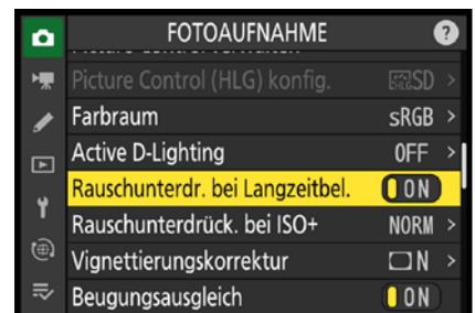
▲ Aktivieren Sie mit dieser Funktion die Rauschunterdrückung bei Langzeitbelichtungen.
