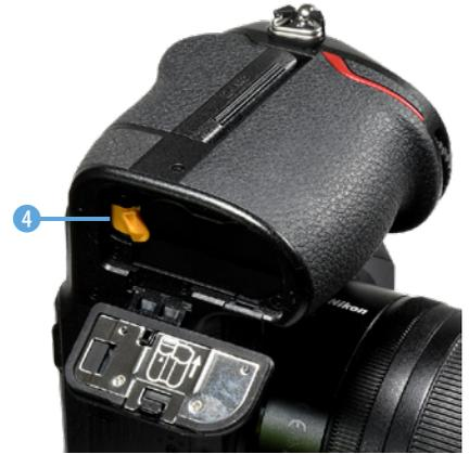
▲ Drücken Sie die Verriegelung nach hinten, um den Akku zu entnehmen.
