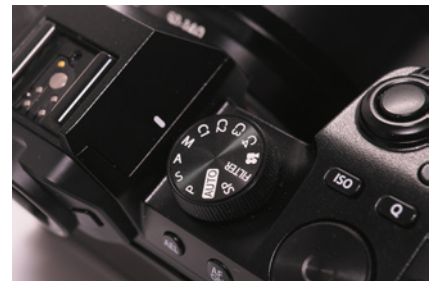
▲ Im manuellen Belichtungsmodus behalten Sie selbst die Kontrolle über Blende und Belichtungszeit.
