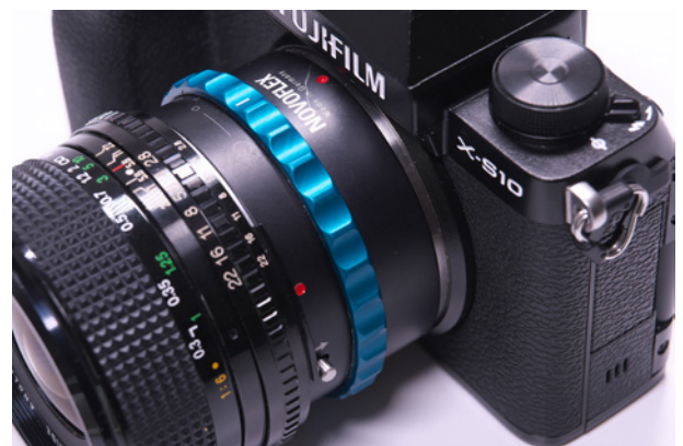
▲ Fremdobjektiv mit Adapter angeschlossen.
