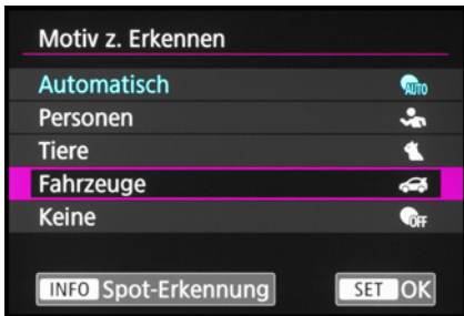
▲ Die benötigten Bedienungselemente werden eingeblendet, hier die INFO-Taste zum Ein- bzw. Ausschalten der Spot-Erkennung (Fahrzeugdetaillerkennung).
