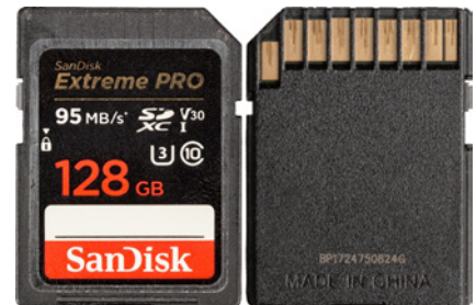
▲ SDXC-Karte mit 128 GB Volumen, UHS-I, Speed Class U3, Video Class V30.
