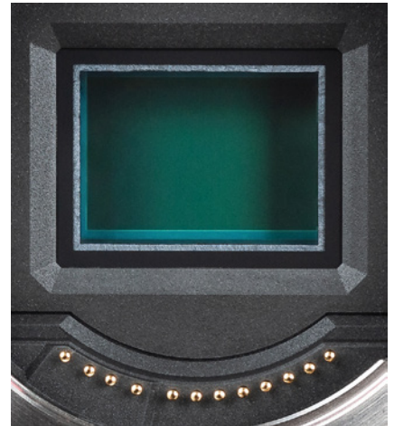
▲ Blick auf den CMOS-Sensor. Das RF-Bajonett hat zwölf Kontakte für die Kommunikation zwischen Objektiv und Gehäuse.
