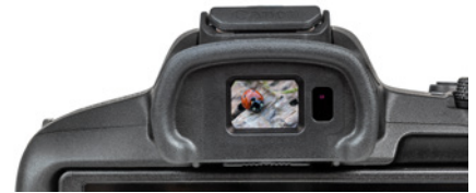
▲ Elektronischer OLED-Farbsucher mit 2,36 Millionen Pixeln, 100 % Bildfeldabdeckung und einer Bilddiagonalen von 0,39 Zoll (ca. 1 cm).
