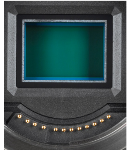
▲ Blick auf den CMOS-Sensor. Darunter hat das RF Bajonett zwölf Kontakte für die Kommunikation zwischen Objektiv und Gehäuse.
