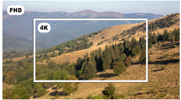
▲ 4K UHD liefert einen um etwa 1,54-fach engeren Bildausschnitt als die Movie-Aufnahmegrößen FHD und HD.
