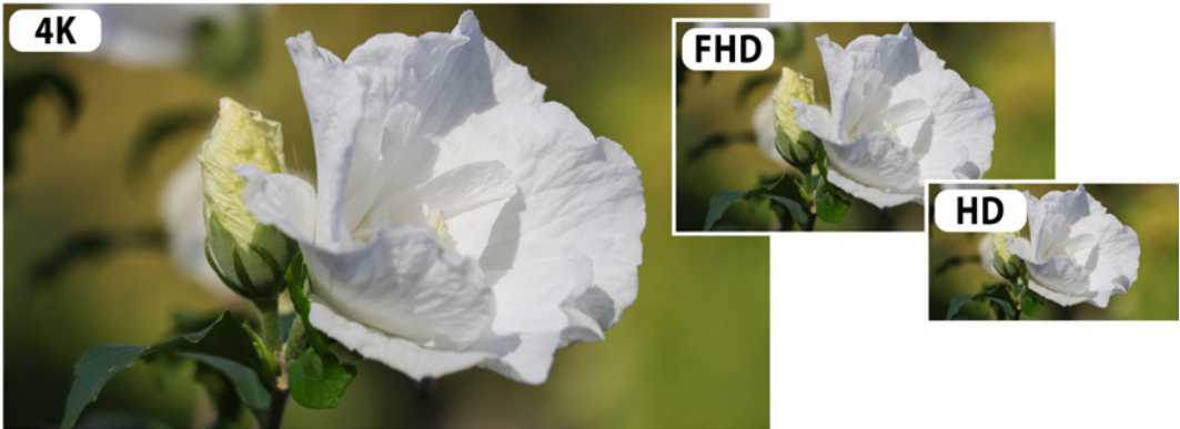
▲ Die Movie-Bildgrößen 4K (3840 × 2160 Pixel), FHD (1920 × 1080 Pixel) und HD (1280 × 720 Pixel) im Verhältnis zueinander.
