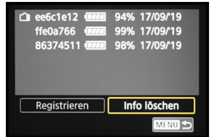
▲ Drei Akkus wurden registriert, der obere ist aktuell in der Kamera eingelegt.
