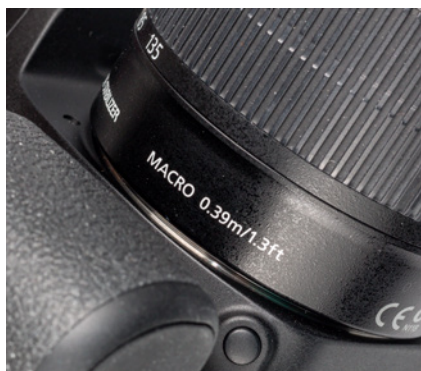
▲ Die Naheinstellgrenze des Objektivs Canon EF-S 18-135 mm f/3,5-5,6 IS STM beträgt 39 cm. Im Telebereich ist die Vergrößerungsleistung am höchsten.
