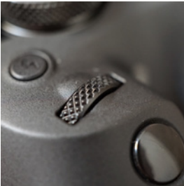
▲ Mit dem Hauptwahlrad können je nach Einstellung u. a. Blende, Verschlusszeit oder Belichtungskorrektur angepasst werden.
