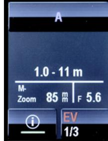
▲ Das Blitzgerät befindet sich im Computerblitzmodus A und zeigt im Display den Entfernungsbereich in Abhängigkeit von den von der Kamera übertragenen Werten für Blende und ISO an.
