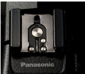
▲ Wird der Blitz nur wenige Millimeter aus dem Blitzschuh der Kamera geschoben, ist die Kommunikation über die Steuerkontakte zwischen Blitzgerät und Kamera unterbrochen. Mit diesem Trick können kürzere Belichtungszeiten vorgewählt werden.
