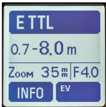
▲ *Bei kompatiblen Fremdblitzgeräten wird die E-TTL-II-Funktion auf dem Display angezeigt.*
