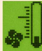
▲ Das SB-5000 verfügt über ein Kühlsystem, das den Blitz vor Überhitzung schützt und im Blitzmenü aktiviert wird. Ein kleines Symbol im LCD mit einem Ventilator zeigt an, dass der Lüfter eingeschaltet ist und für Kühlung sorgt.
