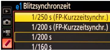
▲ Bei Nikon-Kameras wird die FP-Kurzzeitsynchronisation entweder zunächst im Menü aktiviert oder direkt am Blitzgerät eingeschaltet.
