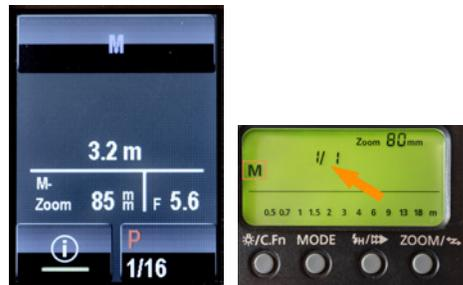
▲ Im Modus M wird die fixe Entfernung in Abhängigkeit von ISO-Wert, Blende und Reflektorposition im LCD angezeigt. Unten rechts wird die zuvor gewählte Teillichtleistungsstufe 1/16 eingeblendet.
