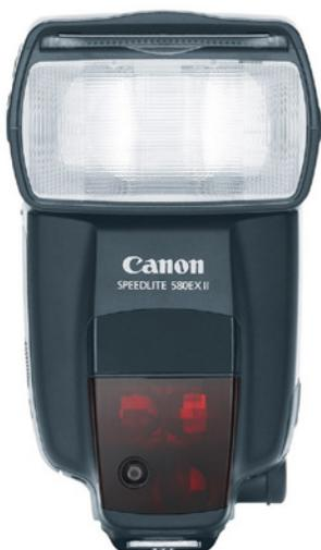
▲ *Das Canon Speedlite 580EX II, ausgestattet mit der fortschrittlichen E-TTL-II-Technik. Der Messblitz, ein Linearblitz aus ca. 20 verschmelzenden Impulsen, hat bei Canon eine deutlich längere Brenndauer (ca. 0,5 Millisekunden) als der Hauptblitz, der nach 55 Millisekunden folgt und mit nahezu voller Intensität abbrennt.*
