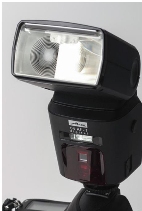
▲ Alternativ können Sie auch ein Blitzgerät mit einem kleinen Zweitreflektorblitz auf der Gerätevorderseite einsetzen, um die Schatten im Vordergrund aufzuhellen. (Abb. Metz)
