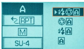
▲ Die Messblitze (Doppelblitzsymbol) können in beiden Computerblitzmodi an- bzw. ausgeschaltet werden. Sie dienen der exakten Bewertung der Lichtsituation und werden von der Fotodiode auf der Frontseite des Blitzgeräts ausgewertet.
