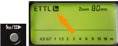
▲ Drücken Sie am Canon-Blitzgerät die Taste mit dem Blitzsymbol, gefolgt vom Buchstaben H, um in den komfortablen High-Speed-Modus zu wechseln.
