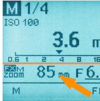
▲ Im LC-Display des Blitzgeräts wird die aktuelle Position des Blitzreflektors angezeigt (z. B. 85 mm Ausleuchtwinkel).
